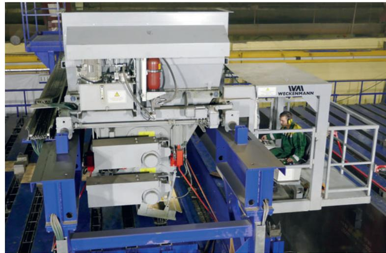
Halbportal Betonverteiler beim Betonieren
